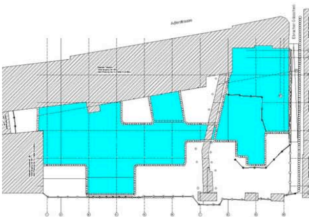
Bild 2: Baugrubenkonzept Weiß: Im Schutz der Wasserhaltung
